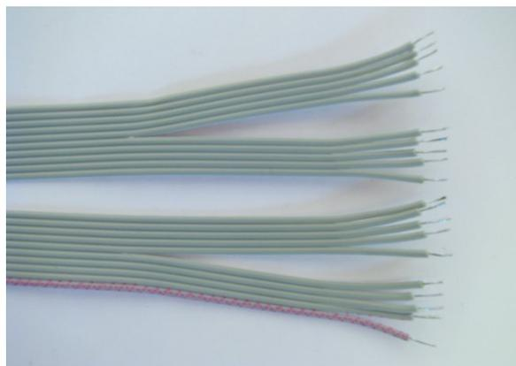
Die einzelnen Adern werden nun an der Displayplatine in der numerischen Reihenfolge fest gelötet:
