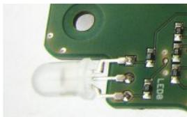
Die LEDs werden von der Bauteilseite bestückt. Nach dem Anlöten wird die LED nach hinten umgebogen (siehe Abbildung).
