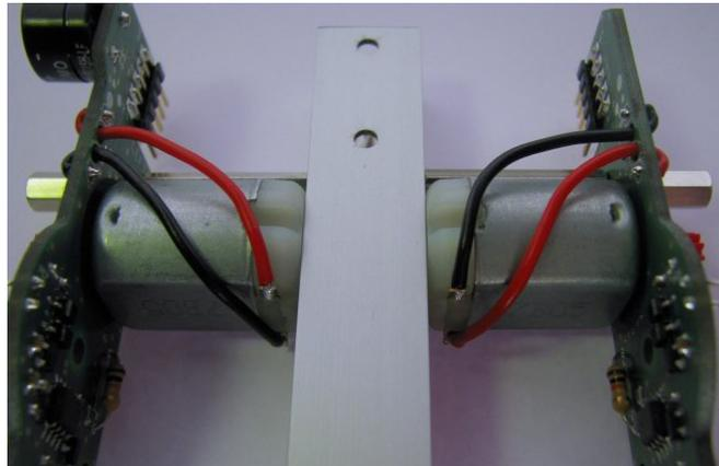
Anschließend wird auf beiden Seiten das Getriebe montiert. Stecken Sie den weißen Kunststoffdistanzring auf die kurze Achse mit dem roten Zahnrad (auf die dem kleinen Zahnrad gegenüberliegende Seite). Dann wird diese Achse mit dem Distanzring voran in die Bohrung unterhalb der IR-LED (IRL80A) gesteckt. Anschließend stecken Sie die lange Achse mit dem weißen Zahnrad (mit dem kleinen Zahnrad nach außen) in die Bohrung neben dem Nibo Logo:
