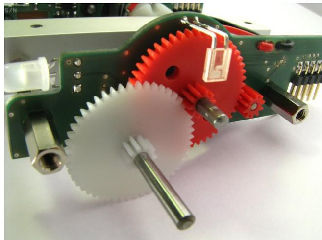
Das Getriebe wird mit einer Aluminiumabdeckplatte und zwei Innensechskantschrauben fixiert. Analog verfährt man auf der anderen Seite.
