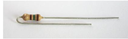
Der Widerstand wird senkrecht in die Platine eingelötet. Die Beinchen werden dazu, wie auf der Abbildung zu sehen ist, an einer Seite umgebogen. Der Körper des Widerstands wird auf der Platine in das umrandete Lötauge gelötet.
