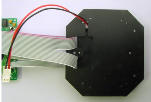
Der zweite Batteriehalter wird von unten an die Kunststoffplatte an den Bohrungen (3) angeschraubt.
