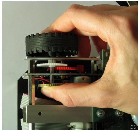
*Tipp:* Ein ruhiges Fahrgeräusch lässt sich durch leichtes Einfetten des Getriebes erzielen.
