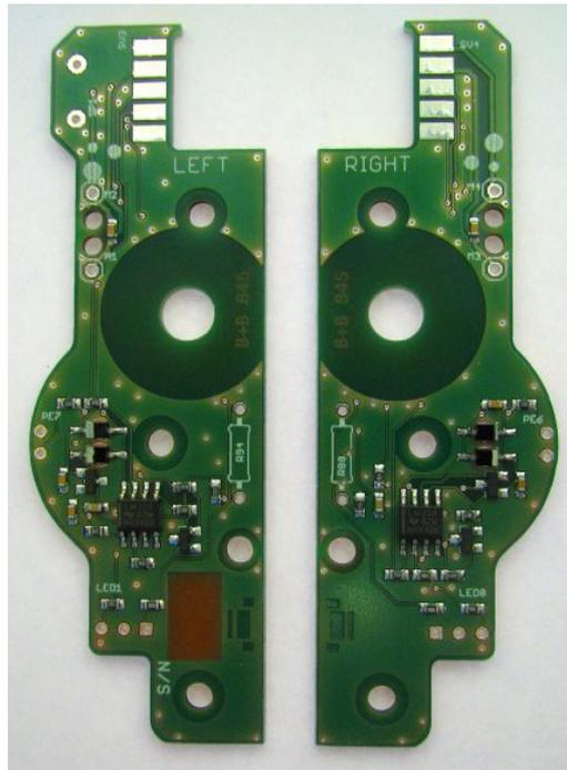
So sollten die OMS-Platinen nach der Bestückung von der Bauteilseite (Oberseite) aussehen:
