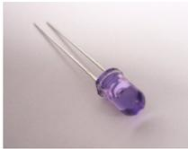
Die IR-LEDs **PE1-PE5** dienen zur Aussendung der IR-Strahlung, sie werden auf der **Oberseite** der Platine in die „**hinteren**“ Lötstellen (siehe Foto) eingelötet.
