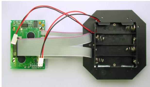
**Für die Ausführung mit Grafikdisplay:** Schrauben Sie nun vier 20 mm Bolzen an den Bohrungen (4) mit den Kreuzschlitzschrauben (Linsenkopf, M2x6) fest.
