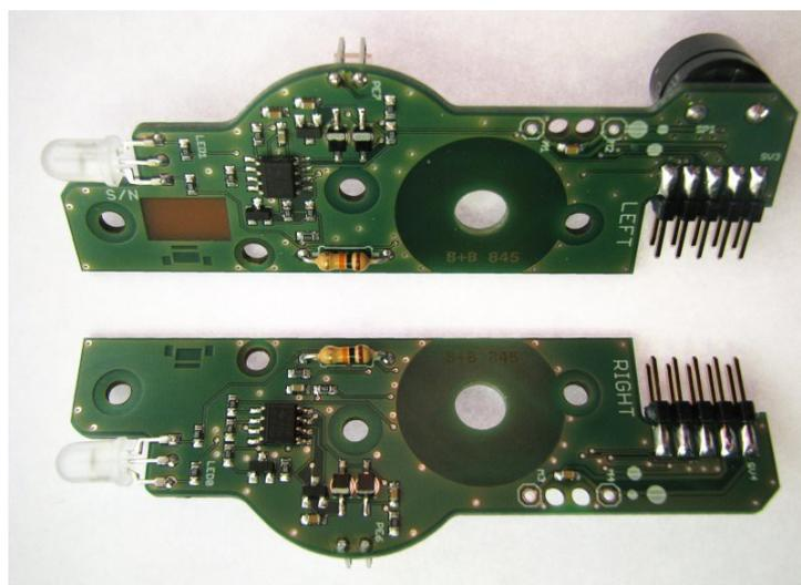
So sollten die OMS-Platinen nach der Bestückung von der Unterseite aussehen:
