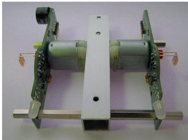
*Tip:* Falls der Motor nicht plan in der Bohrung der OMS-Platine sitzt, kann die Bohrung mit einem 10mm Bohrer von der Motor-Seite aus leicht angefast werden.
