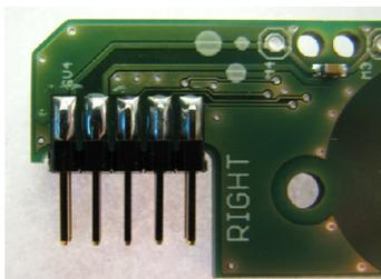
Die 10-poligen Pfostenstecker werden mit den kürzeren Beinchen an die OSM-Platinen angelötet (siehe Abbildung links). Eine Polarität muss dabei nicht beachtet werden. Beim Lötvorgang sollte darauf geachtet werden, dass der Stecker anschließend genau parallel zur Platine ausgerichtet ist (siehe Abbildung rechts).
