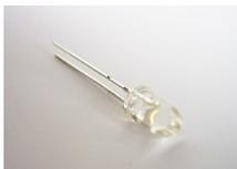
Die beiden weißen LEDs **LED8** und **LED9** werden direkt am Boden der LED abgewinkelt. Dabei muss die **Polarität** beachtet werden: Das **kurze** Beinchen muss jeweils in das **rechteckige** Lötpad.
