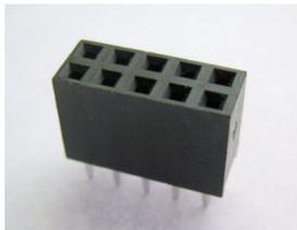
Bei den beiden 10-poligen Pfostenbuchsen **SV1** und **SV2** muss nicht auf die Polarität geachtet werden.
